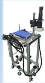
ツマミを回して可動するXYテーブルを標準装備。高倍率での検査を容易に！
